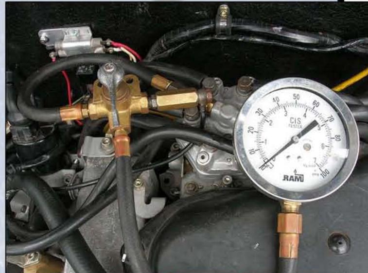
Celle-ci doit être de 3.3bars après coupure, et d'au moins 1.7bars après 10mn. Une chute rapide de pression révèle un défaut d'étanchéité en A, B ou C. Dans ce cas on entend un bruit de ressort qui se détend, répercuté par le châssis. Procéder méthodiquement pour déterminer la fuite.
